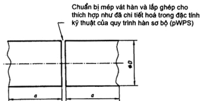
Hình 17. Chi tiết kiểm tra cho mối hàn giáp mép các tấm
